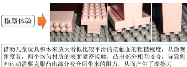
(图8:摩擦力力学模型)
